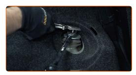
Retirez l'écrou de fixation. Utilisez une douille n° 19.
