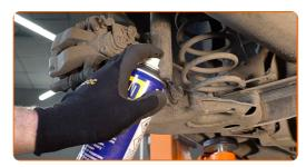
Dévissez l'attache inférieure de l'amortisseur. Utilisez une douille n° 19. Utilisez un porte-taraud.
