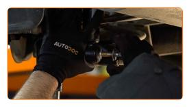
Vissez la fixation inférieure de l'amortisseur. Utilisez une douille n° 19.
