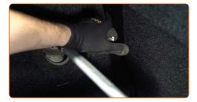
Nettoyez les fixations de l'amortisseur. Utilisez de la graisse au cuivre.
