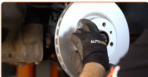
**21** Serrez l'attache du disque de frein. Utilisez une douille n° 12. Utilisez une clé dynamométrique. Serrez-le jusqu'à 10 Nm.
