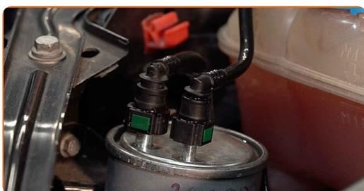
**4** Appuyez sur les clips et détachez les conduites d'admission de carburant du boîtier du filtre à huile. Servez-vous des pinces pour la conduite de carburant.
