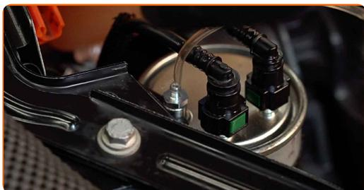
**13** Dévissez la vis de purge du filtre à carburant. Utilisez une clé mixte de No.12.
