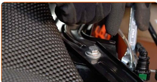
**14** Allumez le contact. C'est nécessaire pour activer la pompe à carburant et permettre à celui-ci de circuler dans le système.
