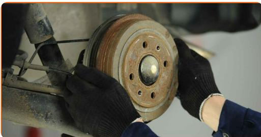
**11** Retirez le capuchon de protection du moyeu de roue. Utilisez un tournevis plat. Servez-vous d'un marteau.
