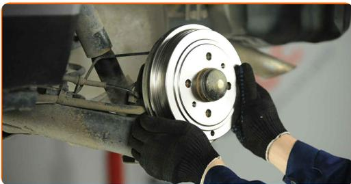
**14** Serrez les fixations des tambours de frein. Utilisez une douille n° 12. Utilisez une clé dynamométrique. Serrez-le jusqu'à 15 Nm.
