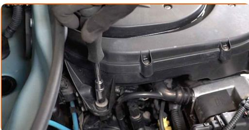
4 Retirez les ressorts de retenue du boîtier de filtre à air.
