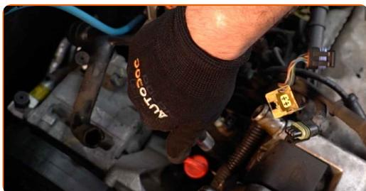
**15** Vissez les nouvelles bougies et serrez-les. Servez-vous de la douille de bougie d'allumage n°16. Utilisez une clé dynamométrique. Serrez-le jusqu'à 27 Nm.
