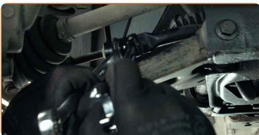
**16** Serrez la fixation reliant la biellette à la barre stabilisatrice. Utilisez une douille n° 17. Utilisez une clé dynamométrique. Serrez-le jusqu'à 55 Nm.
