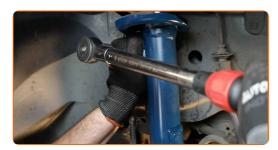
Appliquez du produit sur les fixations de l'amortisseur. Utilisez de la graisse au cuivre.
