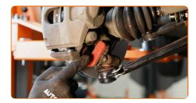
Dévissez l'attache entre le joint rotule et la fusée d'essieu. Utilisez une douille n° 15. Utilisez la mèche Torx T50. Utilisez une clé à cliquet.
