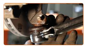
Vissez les fixations de la rotule. Utilisez une douille n° 15. Utilisez la mèche Torx T50. Utilisez une clé à cliquet. 55
