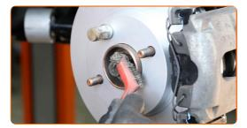
Desserrez la fixation de l'arbre de transmission. Utilisez une douille n° 32. Utilisez un porte-taraud.
