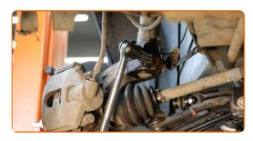
17 Retirez l'écrou de fixation.
