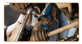
Serrez l'attache du joint rotule. Utilisez une douille n° 15. Utilisez une clé dynamométrique. Serrez-le jusqu'à 48 Nm.
