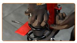
Serrez l'écrou de l'entretoise d'amortisseur due la tige de piston. Utilisez une douille n° 19. Utilisez la clé HEX n° H6. Utilisez une clé dynamométrique. Serrez-le jusqu'à 48 Nm.
