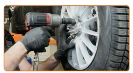
Abaissez la voiture et serrez les boulons de roue en ordre croisé. Servez-vous d'une douille à choc pour roue 70 N°19. Utilisez une clé dynamométrique. Serrez-le jusqu'à 95 Nm.
