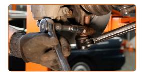
Serrez la fixation reliant la biellette à l'amortisseur. Utilisez une douille n° 17. Utilisez une clé dynamométrique. Serrez-le jusqu'à 48 Nm.
