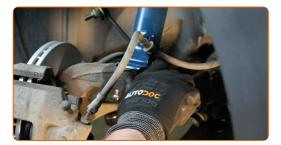
Vissez la fixation qui relie la jambe d'amortisseur à la fusée d'essieu. Utilisez une douille n° 15. Utilisez une clé à cliquet.
