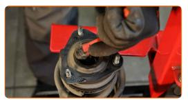
Retirez l'écrou de la tige de piston de l'entretoise. Utilisez la clé HEX n° H6. Utilisez une douille n° 17. Utilisez une clé à cliquet.
