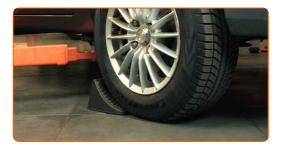
Desserrez les boulons de fixation de la roue. Servez-vous d'une douille à choc pour roue N°19.
