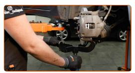
Relâchez la fixation inférieure assurant la connexion entre la jambe d'amortisseur et le porte-fusée. Servez-vous d'une douille spéciale pour retirer l'amortisseur.
