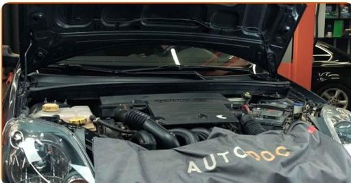
25 Vérifiez le niveau d'huile cinq minutes après l'arrêt du moteur à l'aide d'une jauge, et ajoutez de l'huile si nécessaire.
