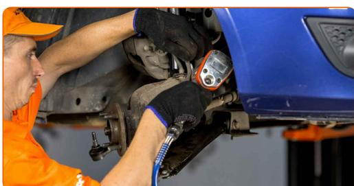
**36** Serrez le moyeu. Utilisez une douille n° 32. Utilisez une clé dynamométrique. Serrez-le jusqu'à 290 Nm.
