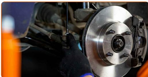
**7** Dévissez l'écrou d'attache d'extrémité à la fusée d'essieu. Utilisez une douille n° 17. Utilisez une clé à cliquet.
