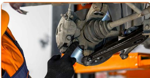
**10** Dévissez l'attache du support d'étrier. Utilisez une douille n° 13. Utilisez une clé à cliquet.
