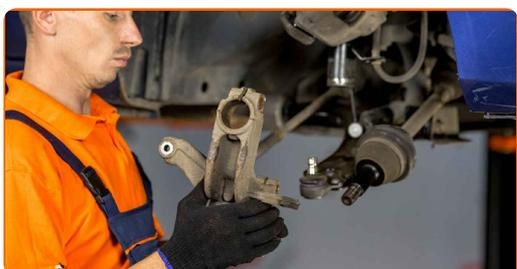
**31** Montez l'arbre de transmission sur le moyeu de roue.
