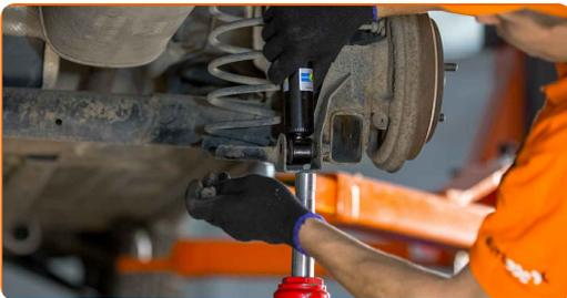
23 Serrez l'attache inférieure de l'amortisseur. Utilisez une douille n° 15. Utilisez une clé dynamométrique. Serrez-le jusqu'à 115 Nm.
