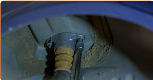
22 Installez l'écrou de fixation.
