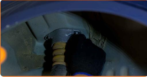
21 Serrez l'attache de l'amortisseur supérieur. Utilisez une douille n° 10. Utilisez une clé dynamométrique. Serrez-le jusqu'à 25 Nm.
