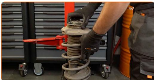
Remplacement : ressort de suspension – Ford Focus DAW. Les professionnels recommandent :
