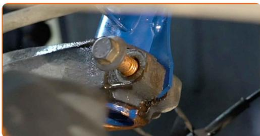
**58** Vissez la fixation qui relie la jambe d'amortisseur à la fusée d'essieu. Utilisez une douille n° 15. Utilisez une clé à cliquet.
