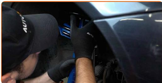
**53** Fixer les fixations supérieures de l'amortisseur (3 pièces). Ne serrez pas trop.
