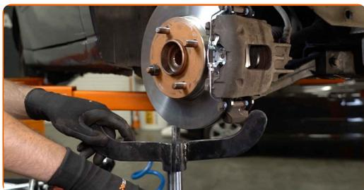
**29** Relâchez la fixation inférieure assurant la connexion entre la jambe d'amortisseur et le porte-fusée. Servez-vous d'une douille spéciale pour retirer l'amortisseur. Utilisez une clé à cliquet.
