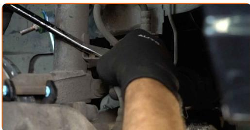
**17** Dévissez les fixations qui lient l'arbre de transmission au moyeu de roue.
