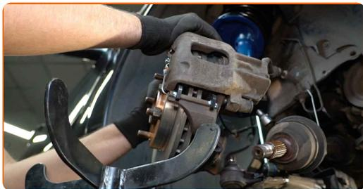
**57** Installez l'écrou de fixation.
