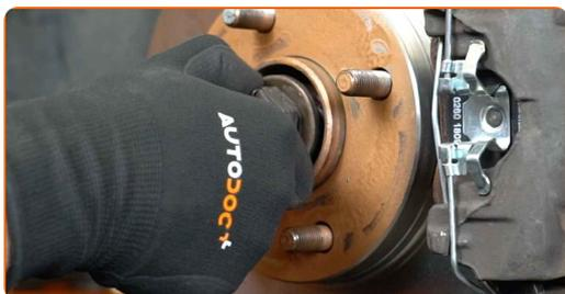
**18** Retirez l'écrou de fixation.
