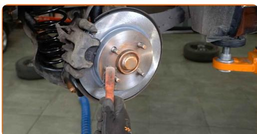
**42** Appliquez du produit sur la zone de contact entre le disque de frein et la jante. Utilisez de la graisse au cuivre.
