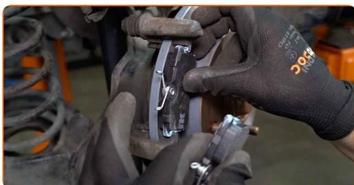
**40** Installez l'étrier de frein et fixez-le. Utilisez une clé mixte de No.15 Utilisez une douille n° 13. Utilisez une clé dynamométrique. Serrez-le jusqu'à 35 Nm.
