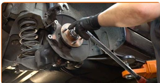
Remplacement : roulement de roue – Ford Focus DAW. Les professionnels recommandent :
