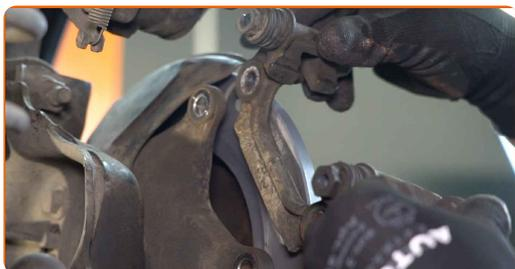
**38** Serrez le support de l'étrier de frein. Utilisez une douille n° 13. Utilisez une clé dynamométrique. Serrez-le jusqu'à 55 Nm.
