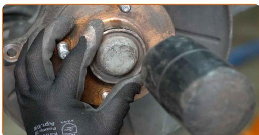
Remplacement : roulement de roue – Ford Focus DAW. Les experts d'AUTODOC recommandent :
