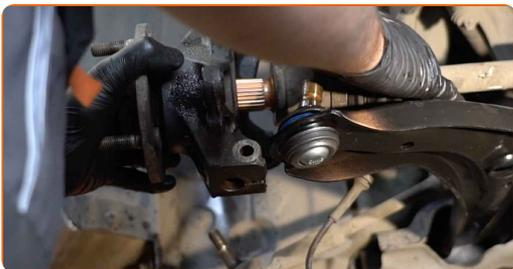
**51** Installez l'écrou de fixation.
