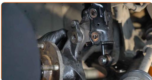
**48** Installez les boulons de fixation.
