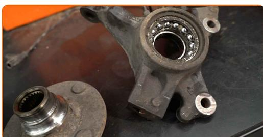
**37** Nettoyez la bague de retenue du roulement de moyeu de la roue. Utilisez une brosse métallique. Servez vous de l'aérosol WD-40.
