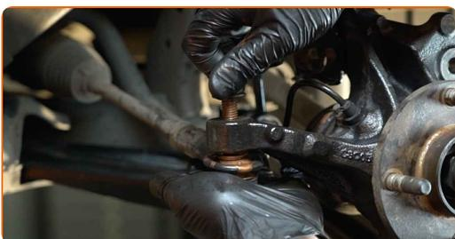
**56** Vissez l'écrou de fixation reliant l'embout de biellette à la fusée d'essieu. Utilisez une douille n° 18. Utilisez une clé à cliquet.
