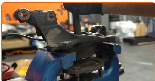
**35** Relâchez l'étau et enlevez le moyeu de roue avec le roulement.
