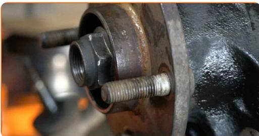
**52** Vissez l'écrou à l'arbre d'entraînement. Utilisez une douille n° 32. Utilisez une clé à cliquet.
