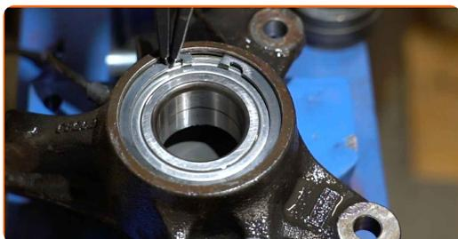
**45** Installez le moyeu de roue sur la fusée d'essieu. Servez-vous d'un coffret de douilles et de roulements.
