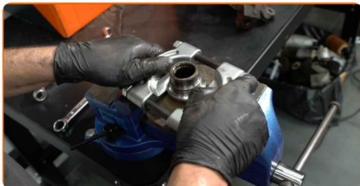
**36** Tirez la bague de roulement intérieure du moyeu de roue. Utilisez un séparateur de roulement. Servez-vous d'un poinçon effilé. Servez-vous d'un marteau.
