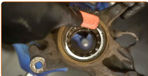
**38** Retirez l'anneau de retenue du palier de moyeu de roue. Utilisez les pinces à anneau de retenue. Utilisez un tournevis plat.
