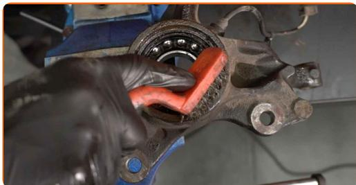
**40** Faites sortir le palier du moyeu de roue. Servez-vous d'un coffret de douilles et de roulements.
