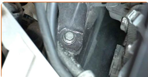
**8** Dévissez les fixations qui relient le support du moteur à la carrosserie. Utilisez une douille n° 18. Utilisez une clé à cliquet.
