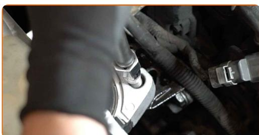
**15** Serrez les fixations qui relient le support du moteur à la carrosserie. Utilisez une douille n° 18. Utilisez une clé dynamométrique. Serrez-le jusqu'à 65 Nm.
