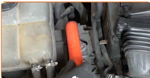
**6** Dévissez la fixation supérieure du support moteur. Utilisez une douille n° 16. Utilisez une clé à cliquet.
