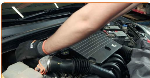
**19** CVissez les boulons de fixation du compartiment filtre. Utilisez une douille n° 10. Utilisez une clé à cliquet.
