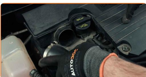
**6** Dévissez les boulons de fixation du compartiment du filtre. Utilisez une douille n° 10. Utilisez une clé à cliquet.
