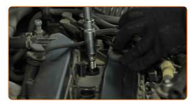
Vissez les nouvelles bougies et serrez-les. Servez-vous de la douille de bougie d'allumage n°16. Utilisez une clé dynamométrique. Serrez-le jusqu'à 20 Nm.
