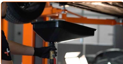
8.1 Dévissez le bouchon de vidange. Utilisez une douille n° 13. Utilisez une clé à cliquet.
