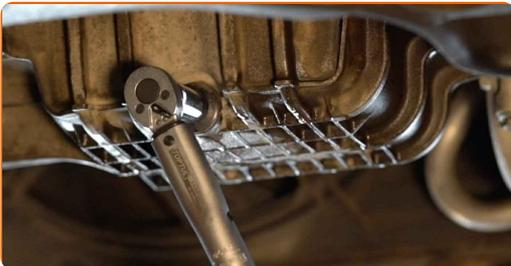
**17** Remettez en place le carénage sous moteur. Serrez les fixations du carénage sous moteur. Utilisez une douille n° 10. Utilisez une clé à cliquet.
