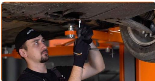
6 Retirez le carénage sous moteur. Utilisez une douille n° 10. Utilisez un tournevis plat. Utilisez une clé à cliquet.
