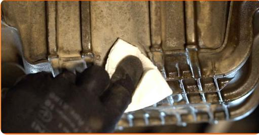
**16** Vissez le nouveau bouchon de vidange et le resserrez. Utilisez une douille n° 13. Utilisez une clé dynamométrique. Serrez-le jusqu'à 27 Nm.
