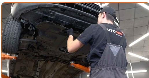
7 Placez un contenant d'huile de vidange d'une capacité de 4 l minimum sous l'orifice de drainage.
