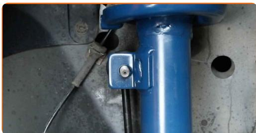
**61** Resserez la fixation de la biellette de la barre stabilisatrice. Utilisez une douille n° 17. Utilisez une clé à cliquet.
