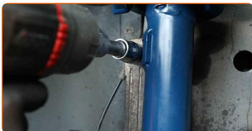
**62** Installez l'écrou de fixation.
