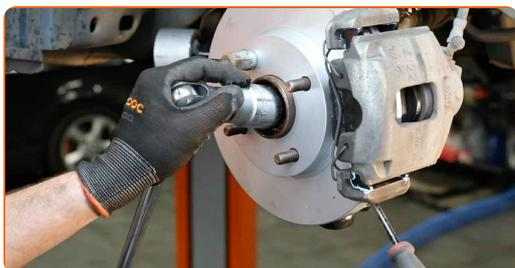
**20** Retirez l'écrou de fixation. Utilisez une douille n° 32.
