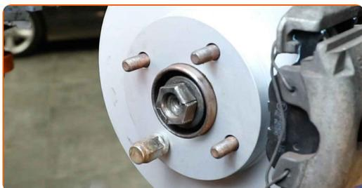
**63** Resserez l'écrou de l'arbre de transmission. Utilisez une douille n° 32. Utilisez une clé dynamométrique. Serrez-le jusqu'à 290 Nm.
