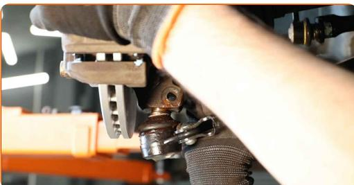
54 Installez l'écrou de fixation.
