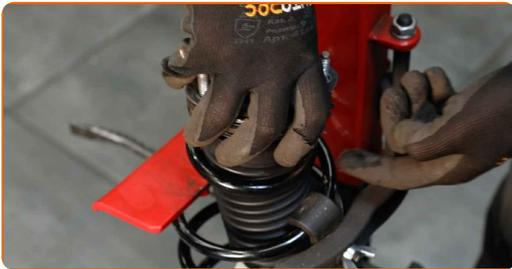
41 Serrez l'écrou de l'entretoise d'amortisseur due la tige de piston. Utilisez une douille n° 19. Utilisez la clé HEX n° H6. Utilisez une clé dynamométrique. Serrez-le jusqu'à 48 Nm.
