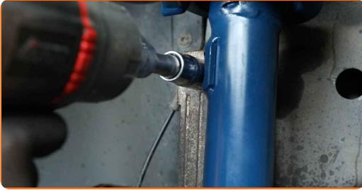
60 Installez l'écrou de fixation.
