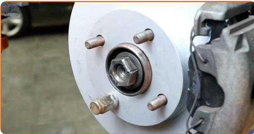
61 Resserez l'écrou de l'arbre de transmission. Utilisez une douille n° 32. Utilisez une clé dynamométrique. Serrez-le jusqu'à 290 Nm.
