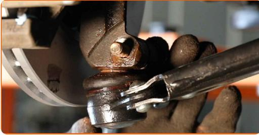
55 Vissez les fixations de la rotule. Utilisez une douille n° 15. Utilisez la mèche Torx T50. Utilisez une clé à cliquet.
