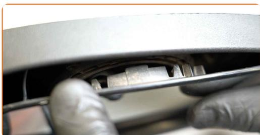
Remplacement : coque de rétroviseur – FORD Fiesta Mk6 Van. Les professionnels recommandent :
