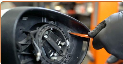
Remplacement : coque de rétroviseur – FORD Fiesta Mk6 Van. AUTODOC recommande :
