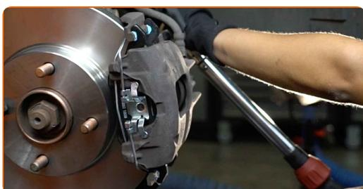
**22** Installez les bouchons anti-poussière des goupilles de guidage de l'étrier de frein.
