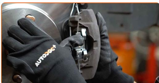
**21** Serrez les fixations de l'étrier de frein. Utilisez la clé HEX n° H7. Utilisez une clé dynamométrique. Serrez-le jusqu'à 28 Nm.
