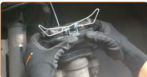
Remplacement : plaquettes de frein – FORD FOCUS Break (DNW). Les professionnels recommandent :
