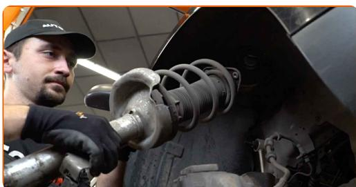
**Remplacement : ressort de suspension – FORD Focus II 3/5 portes (DA\_, HCP, DP). Les professionnels recommandent :**
