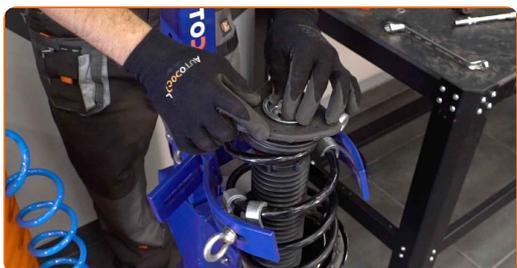
**36** Serrez l'écrou de l'entretoise d'amortisseur due la tige de piston. Utilisez la mèche Torx T30. Utilisez une clé mixte de No.19. Utilisez une clé dynamométrique. Serrez-le jusqu'à 50 Nm.
