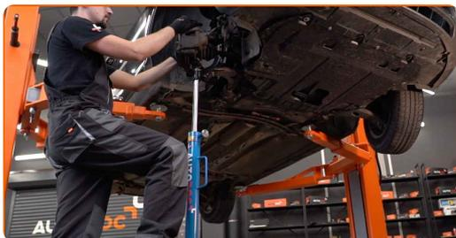
**44** Installez et serrez un nouveau boulon sur la fusée d'essieu. Utilisez une douille n° 18. Utilisez une clé à cliquet. Utilisez une clé dynamométrique. Serrez-le jusqu'à 90 Nm.
