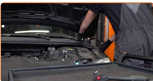
**4** Dévissez les fixations des bras d'essuie-glaces. Utilisez une douille n° 15. Utilisez une clé à cliquet.
