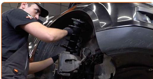
**41** Fixer les fixations supérieures de l'amortisseur (3 pièces). Ne serrez pas trop.
