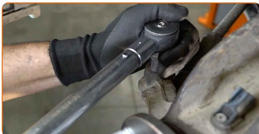
**52** Serrez l'attache du joint rotule. Utilisez une clé mixte de No.21 Utilisez une clé dynamométrique. Serrez-le jusqu'à 70 Nm.
