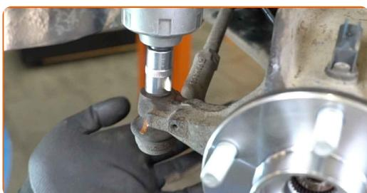
**51** Serrez l'écrou de fixation reliant l'embout de biellette de direction à la fusée d'essieu. Utilisez une douille n° 15. Utilisez une clé dynamométrique. Serrez-le jusqu'à 48 Nm.
