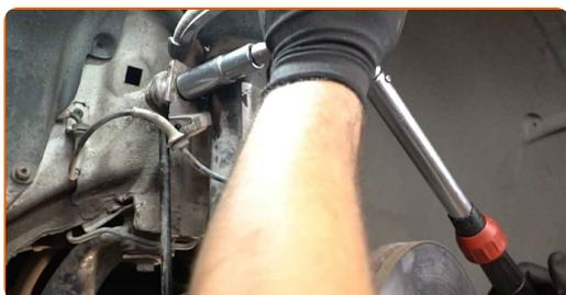
**65** Appliquez du produit sur les fixations de l'amortisseur. Appliquez du produit sur la fixation reliant l'embout de biellette de direction à la fusée d'essieu. Appliquez du produit sur les fixations de la rotule. Utilisez de la graisse au cuivre.
