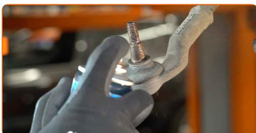
**49** Connectez l'extrémité du tirant à la fusée d'essieu.
