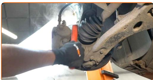
**18** Dévissez l'attache du support d'étrier. Utilisez une douille n° 15. Utilisez un porte-taraud. Utilisez une clé à cliquet.
