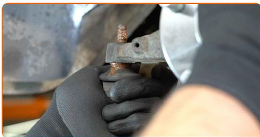
**50** Vissez l'écrou de fixation reliant l'embout de biellette à la fusée d'essieu. Utilisez une douille n° 15. Utilisez une clé à cliquet.
