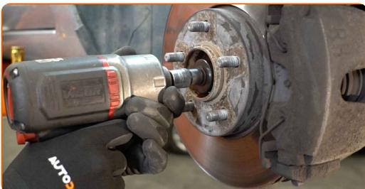
**13** Retirez l'écrou de fixation.
