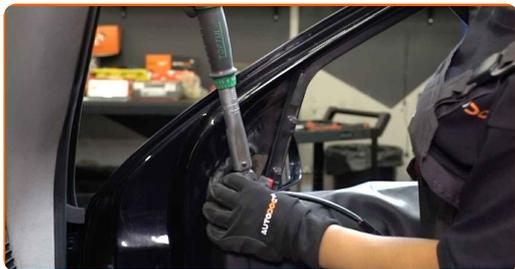
**11** Appliquez du produit sur le connecteur du commutateur de la vitre électrique. Utilisez de la graisse diélectrique.
