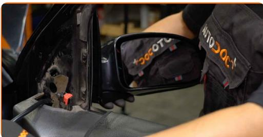
**10** Serrez les vis du rétroviseur. Utilisez une douille n° 10. Utilisez une clé dynamométrique. Serrez-le jusqu'à 8 Nm.
