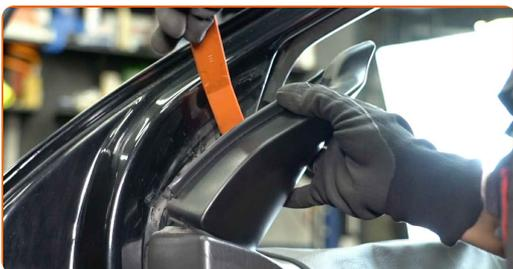
4 Débranchez le câblage du rétroviseur. Utilisez un outil d'extraction de clips.
