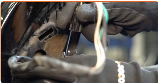
**6** Retirez les vis du rétroviseur. Utilisez une douille n° 10. Utilisez une clé à cliquet.
