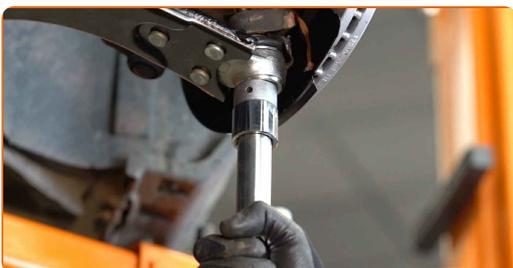
20 Installez l'écrou de fixation du joint à bille.
