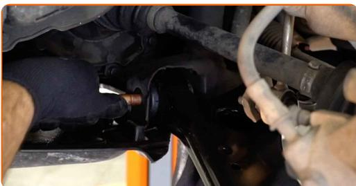
18 Connectez le joint rotule à la fusée d'essieu.
