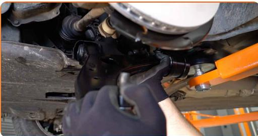
Remplacement : bras inférieur avant – FORD Focus Mk2 3/5 portes (DA\_, HCP, DP). Les experts d'AUTODOC recommandent :
