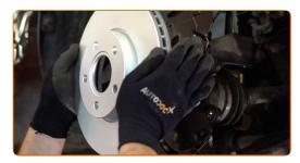
Nettoyez la graisse anti-corrosion du nouveau disque de frein. Servez-vous d'un nettoyant pour freins.
