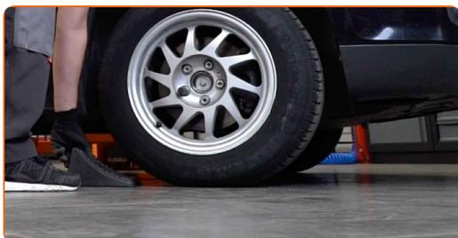
13 Desserrez les boulons de fixation de la roue. Servez-vous d'une douille à choc pour roue N°19.
