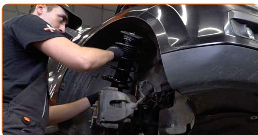
44 Fixer les fixations supérieures de l'amortisseur (3 pièces). Ne serrez pas trop.
