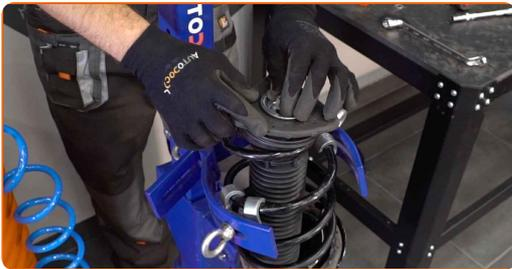
39 Serrez l'écrou de l'entretoise d'amortisseur due la tige de piston. Utilisez la clé HEX n° H6. Utilisez une clé mixte de No.19. Utilisez une clé dynamométrique. Serrez-le jusqu'à 50 Nm.
