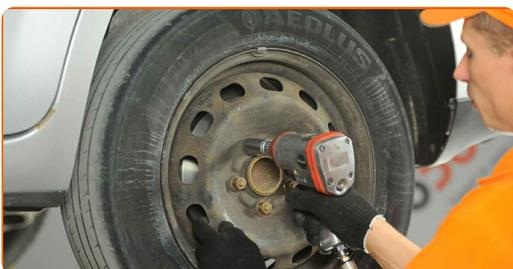
**30** Abaissez la voiture et serrez les boulons de roue en ordre croisé. Servez-vous d'une douille à choc pour roue N°19. Utilisez une clé dynamométrique. Serrez-le jusqu'à 120 Nm.
