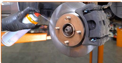
Remplacement : plaquettes de frein – FORD Focus Mk2 Van / Break.
