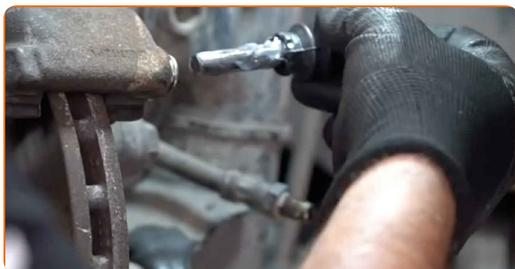
**23** Serrez les fixations de l'étrier de frein. Utilisez la clé HEX n° H7. Utilisez une clé dynamométrique. Serrez-le jusqu'à 35 Nm.
