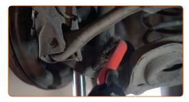
Dévissez l'attache inférieure de l'amortisseur. Utilisez une douille n° 16. Utilisez une clé à cliquet. Utilisez un portetaraud.
