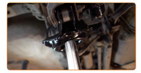
Nettoyez le siège de fixation de la jante. Utilisez une brosse métallique. Traitez la surface de contact. Utilisez de la graisse au cuivre.
