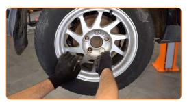
Abaissez la voiture et serrez les boulons de roue en ordre croisé. Utilisez une clé dynamométrique. Serrez-le jusqu'à 110 Nm.
