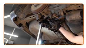
Serrez les attaches du support d'amortisseur. Utilisez une douille n° 10. Utilisez une clé dynamométrique. Serrezle jusqu'à 25 Nm.
