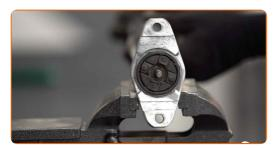
Fixez le support de l'amortisseur. Utilisez une clé mixte de No.13. Utilisez une douille n° 13. Utilisez une clé dynamométrique. Servez-vous d'une clé ajustable. Serrez-le jusqu'à 25 Nm.
