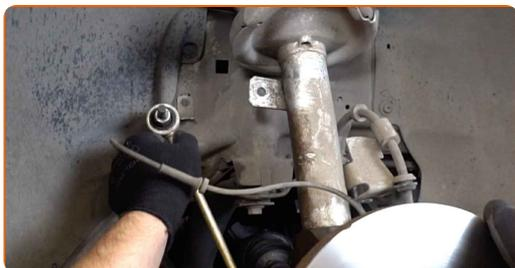
**20** Dévissez la fixation inférieure assurant la connexion entre la jambe d'amortisseur et le porte-fusée. Utilisez une douille n° 18. Utilisez une clé à cliquet. Utilisez un porte-taraud.
