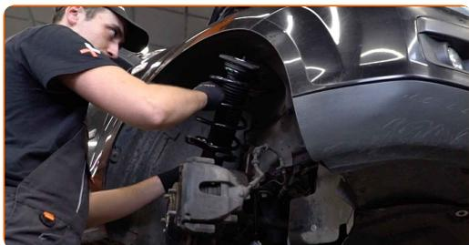
**40** Fixer les fixations supérieures de l'amortisseur (3 pièces). Ne serrez pas trop.
