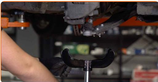
**22** Relâchez la fixation inférieure assurant la connexion entre la jambe d'amortisseur et le porte-fusée. Servez-vous d'une douille spéciale pour retirer l'amortisseur. Servez-vous d'un marteau. Servez-vous d'un burin plat pour l'usinage des métaux.
