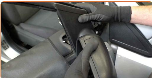
**12** Serrez les vis du rétroviseur. Utilisez la mèche Torx T25. Utilisez une douille n° 10. Utilisez une clé dynamométrique. Serrez-le jusqu'à 5 Nm.
