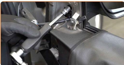
**13** Fixez le connecteur de réglage du rétroviseur à la portière.
