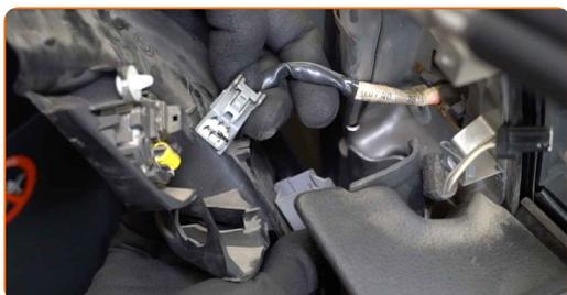
**9** Retirez les vis du rétroviseur. Utilisez la mèche Torx T25. Utilisez une douille n° 10. Utilisez une clé à cliquet.
