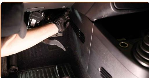
**12** Remplacez la pédale d'accélération à sa position d'origine et vissez sa fixation. Utilisez une douille n° 10. Utilisez une clé à cliquet.
