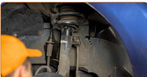
**47** Serrez la fixation reliant la biellette à l'amortisseur. Utilisez une clé mixte de No.15. Utilisez la clé HEX n° H6. Utilisez une clé dynamométrique. Serrez-le jusqu'à 48 Nm.
