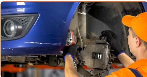
**43** Appliquez du produit sur les fixations de l'amortisseur. Utilisez de la graisse au cuivre.
