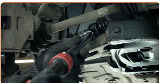
**17** Serrez la fixation reliant la biellette à l'amortisseur. Utilisez une douille n° 17. Utilisez une clé dynamométrique. Serrez-le jusqu'à 48 Nm.
