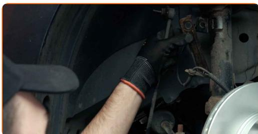
Remplacement : biellette de barre stabilisatrice – FORD FUSION (JU\_) Les experts d'AUTODOC recommandent :
