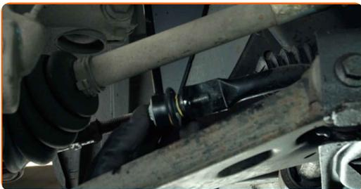
**15** Resserez la fixation de la biellette de la barre stabilisatrice. Utilisez une clé mixte de No.17 (2 pièces).
