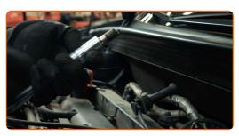
Appliquez une fine couche d'antigrippant à haute température sur les fils des nouvelles bougies d'allumage.
