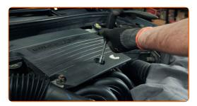
Attachez le tuyau de ventilation du carter à gauche du cache moteur.
