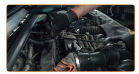
Vissez les nouvelles bougies et serrez-les. Servez-vous de la douille de bougie d'allumage n°16. Utilisez une clé dynamométrique. Serrez-le jusqu'à 15 Nm.
