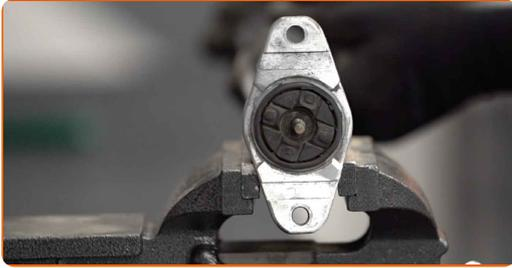
**17** Vissez l'attache supérieure de la tige de piston de l'amortisseur. Utilisez une clé mixte de No.13. Utilisez une douille n° 13. Servez-vous d'une clé ajustable. Utilisez une clé dynamométrique. Serrez-le jusqu'à 25 Nm.
