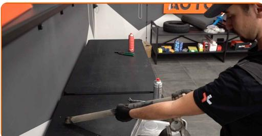
**16** Installez la nouvelle coupelle, le manchon et la butée de suspension sur l'amortisseur.
