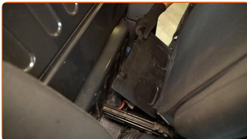
**4** Dévissez la fixation de la borne négative de la batterie. Utilisez une douille de 10 mm. Utilisez une clé à cliquet.
