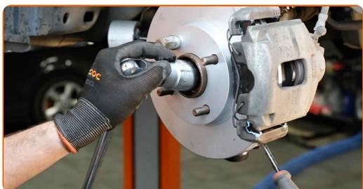
**14** Retirez l'écrou de fixation.
