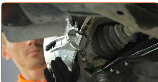
**62** Installez les boulons de fixation (2 pièces).
