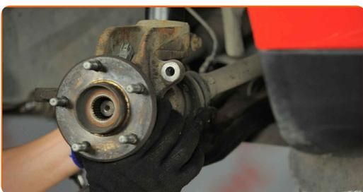
**55** Connectez le joint rotule à la fusée d'essieu.
