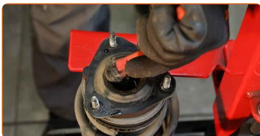
**40** Retirez l'écrou de la tige de piston de l'entretoise. Utilisez une clé mixte de No.18. Utilisez la clé HEX n° H6. Utilisez une clé à cliquet.
