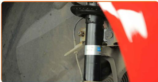
**70** Serrez la fixation reliant la biellette à l'amortisseur. Utilisez une clé mixte de No.17. Utilisez la clé HEX n° H5. Utilisez une clé dynamométrique. Serrez-le jusqu'à 48 Nm.
