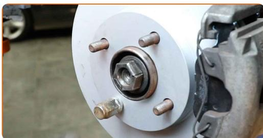
**73** Resserrez l'écrou de l'arbre de transmission. Utilisez une douille n° 32. Utilisez une clé dynamométrique. Serrez-le jusqu'à 290 Nm.
