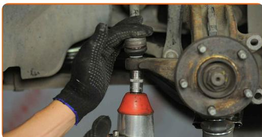
**67** Appliquez du produit sur la fixation reliant l'embout de biellette de direction à la fusée d'essieu. Utilisez de la graisse au cuivre.
