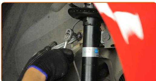
**71** Attachez le connecteur du capteur ABS.
