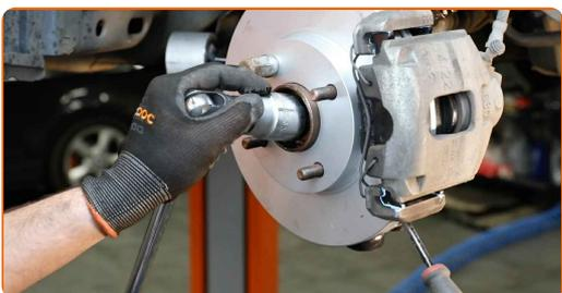
**14** Retirez l'écrou de fixation.
