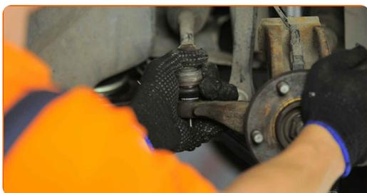
**66** Serrez l'écrou de fixation reliant l'embout de biellette de direction à la fusée d'essieu. Utilisez une douille n° 15. Utilisez une clé dynamométrique. Serrez-le jusqu'à 40 Nm.
