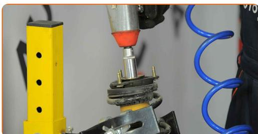
**41** Retirez le support de l'amortisseur, ainsi que le soufflet et la butée. Utilisez un tournevis plat.
