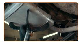
Dévissez les fixations de la protection thermique d'échappement. Utilisez une douille n° 10. Utilisez une clé à cliquet.
