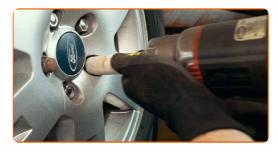
Abaissez la voiture et serrez les boulons de roue en ordre croisé. Servez-vous d'une douille à choc pour roue N°19. Utilisez une clé dynamométrique. Serrez-le jusqu'à 90 Nm.
