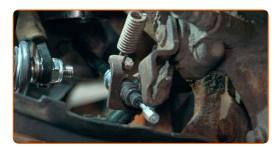
Ajustez la tension du câble du frein de stationnement. Utilisez une douille n° 16. Utilisez une clé à cliquet.
