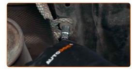
Retirez la protection thermique d'échappement.
