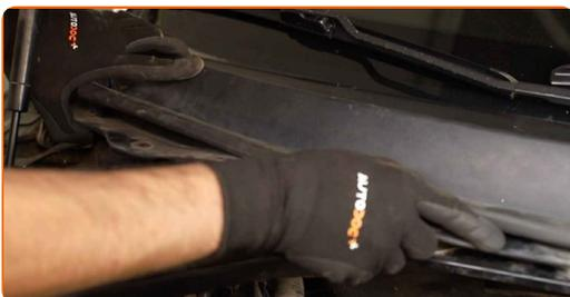
12 Vissez les fixations de la grille d'auvent situées du côté droit. Utilisez la mèche Torx T30. Utilisez une clé à cliquet.
