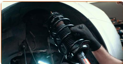
**45** Fixer les fixations supérieures de l'amortisseur (3 pièces). Ne serrez pas trop.
