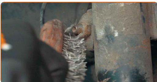
**14** Dévissez la fixation reliant la biellette à l'amortisseur. Utilisez une douille n° 17. Utilisez une clé à cliquet.
