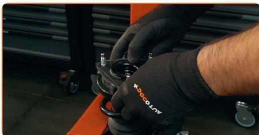
**39** Serrez l'écrou de l'entretoise d'amortisseur due la tige de piston. Utilisez une douille n° 19. Utilisez la clé HEX n° H6. Utilisez une clé dynamométrique. Serrez-le jusqu'à 55 Nm.
