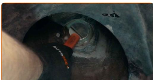
**43** Lubrifiez la barre d'amortisseur. Utilisez de la graisse au cuivre.
