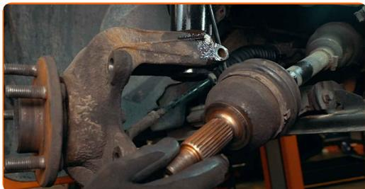
**28** Relâchez la fixation inférieure assurant la connexion entre la jambe d'amortisseur et le porte-fusée. Servez-vous d'une douille spéciale pour retirer l'amortisseur. Utilisez une clé à cliquet.
