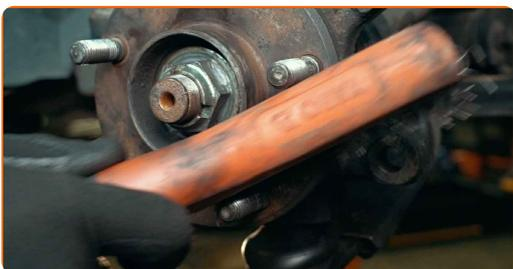
**57** Traitez la surface de contact. Utilisez de la graisse au cuivre.
