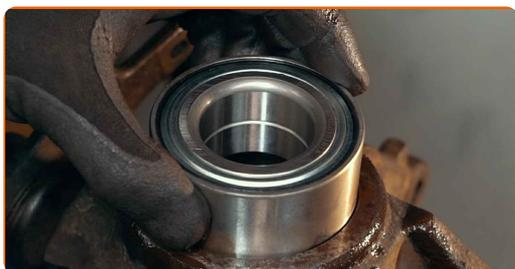
**Remplacement : roulement de roue – FORD MONDEO III (B5Y). AUTODOC recommande :**
