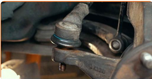
**52** Vissez l'écrou de fixation reliant l'embout de biellette à la fusée d'essieu. Utilisez une douille n° 15. Utilisez une clé à cliquet.
