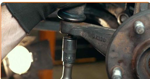
**53** Serrez l'écrou de fixation reliant l'embout de biellette de direction à la fusée d'essieu. Utilisez une douille n° 15. Utilisez une clé dynamométrique. Serrez-le jusqu'à 40 Nm.
