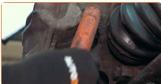
**12** Dévissez l'attache du support d'étrier. Utilisez une douille n° 15. Utilisez une clé à cliquet. Utilisez un porte-taraud.
