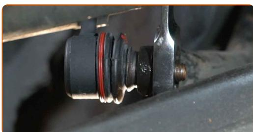
**13** Serrez la fixation reliant la biellette à l'amortisseur. Utilisez une clé mixte de No.17 Utilisez une douille n° 17. Utilisez une clé dynamométrique. Serrez-le jusqu'à 48 Nm.
