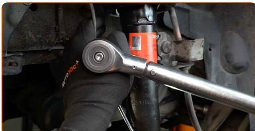
**14** Serrez la fixation reliant la biellette à la barre stabilisatrice. Utilisez une clé mixte de No.17 Utilisez une douille n° 17. Utilisez une clé dynamométrique. Serrez-le jusqu'à 48 Nm.
