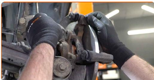
**24** Serrez le support de l'étrier de frein. Utilisez une douille n° 13. Utilisez une clé dynamométrique. Serrez-le jusqu'à 65 Nm.
