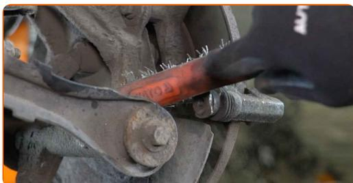
**14** Dévissez l'attache du support d'étrier. Utilisez une douille n° 13. Utilisez une clé à cliquet. Utilisez un porte-taraud.
