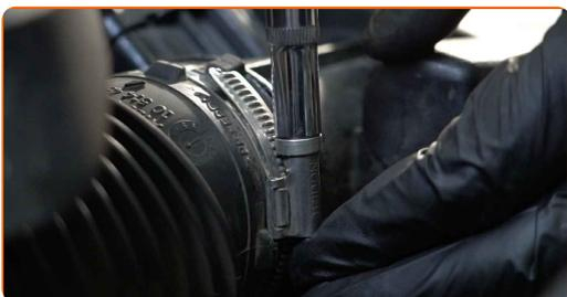
**35** Connectez le tuyau de ventilation du carter au conduit d'air.
