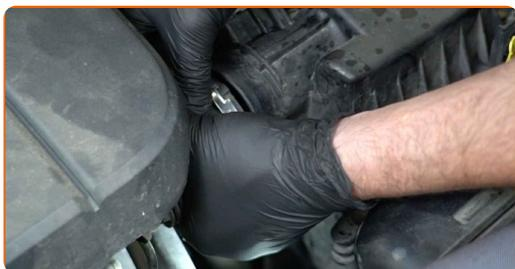
**12** Séparez le tuyau de ventilation du carter du conduit de ventilation.
