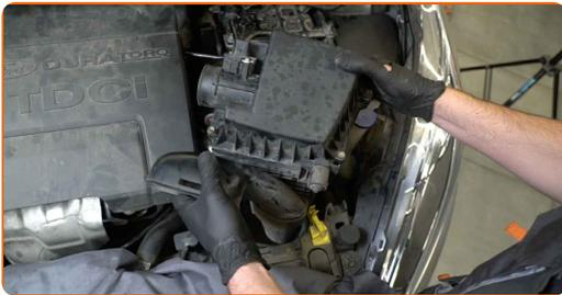
**14** Recouvrez la durite d'admission d'air avec un chiffon microfibre pour empêcher que des particules n'entrent dans le système.
