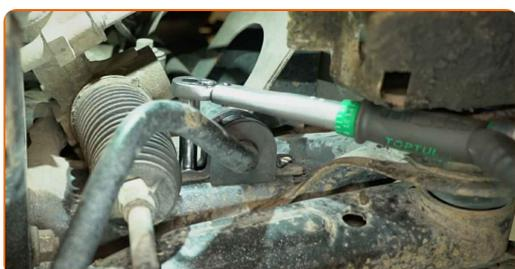
**23** Nettoyez les sièges de montage de la biellette de barre stabilisatrice d'un côté de l'essieu. Utilisez une brosse métallique. Utilisez un spray nettoyant multi-usages.
