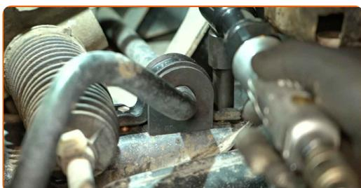
**22** Serrez les fixations des deux supports des bagues de barre stabilisatrice. Utilisez une douille de 10 mm. Utilisez une clé dynamométrique. Couple de serrage : 25 N.m.
