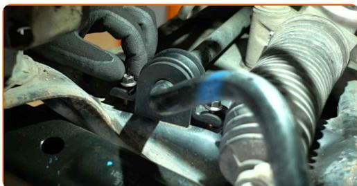
**21** Suivez les mêmes étapes pour installer une bague de barre stabilisatrice et un support neufs de l'autre côté.
