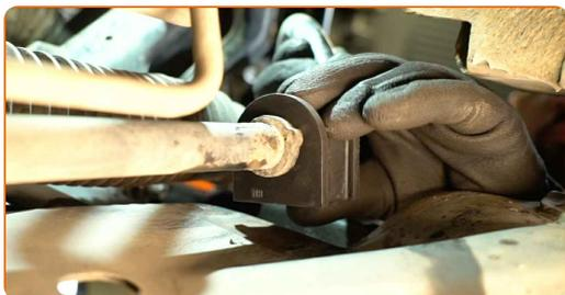
**19** Installez le support de la bague de la barre stabilisatrice.
