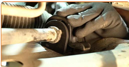
**20** Installez et vissez les boulons de fixation.
