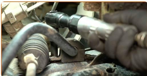
**13** Retirez les boulons de fixation.
