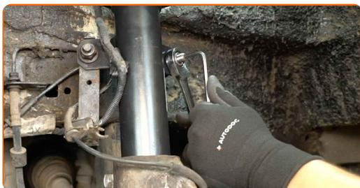
**11** Nettoyez les sièges de montage de la biellette de barre stabilisatrice d'un côté de l'essieu. Utilisez une brosse métallique. Utilisez un spray nettoyant multi-usages.
