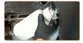
Serrez la vis de purge de frein. Utilisez une douille de 11 mm. Utilisez une clé dynamométrique. Couple de serrage : 9 Nm.
