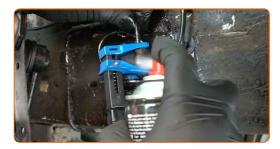
Nettoyez la zone où le flexible de frein se raccorde à l'étrier. Utilisez une brosse métallique. Utilisez un nettoyant pour freins.
