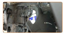
Desserrez le raccord d'écrou qui relie le tuyau de frein au flexible de frein. Utilisez une clé à écrou évasé de 11 mm. Utilisez une clé mixte de 17 mm.
