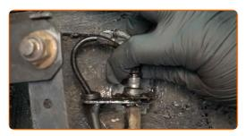
Obturez le tuyau de frein. Utilisez un bouchon de conduite de fluide.
