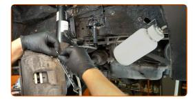
Desserrez la vis de purge de frein. Utilisez une clé mixte de 11 mm.
