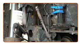
Nettoyez le siège de montage du flexible de frein sur le tuyau de frein. Utilisez une brosse métallique. Utilisez un nettoyant pour freins.
