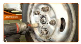
Abaissez la voiture et serrez les écrous de roue en ordre croisé. Utilisez une douille à choc pour jantes 21 mm.
