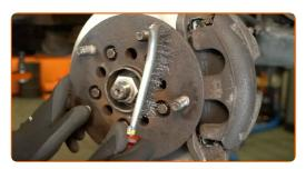
Traitez la surface du moyeu de roue en contact avec la jante de roue. Utilisez de la graisse céramique.
