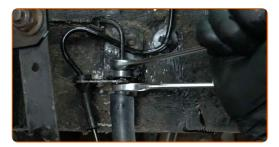
Serrez l'écrou du flexible de frein sur l'étrier de frein. Utilisez une clé à écrou évasé de 11 mm. Utilisez une clé à écrou évasé de 11 mm. Utilisez une clé dynamométrique. Couple de serrage : 15 Nm.
