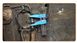
Détachez le flexible de frein de l'étrier de frein. Utilisez une clé à écrou évasé de 11 mm.
